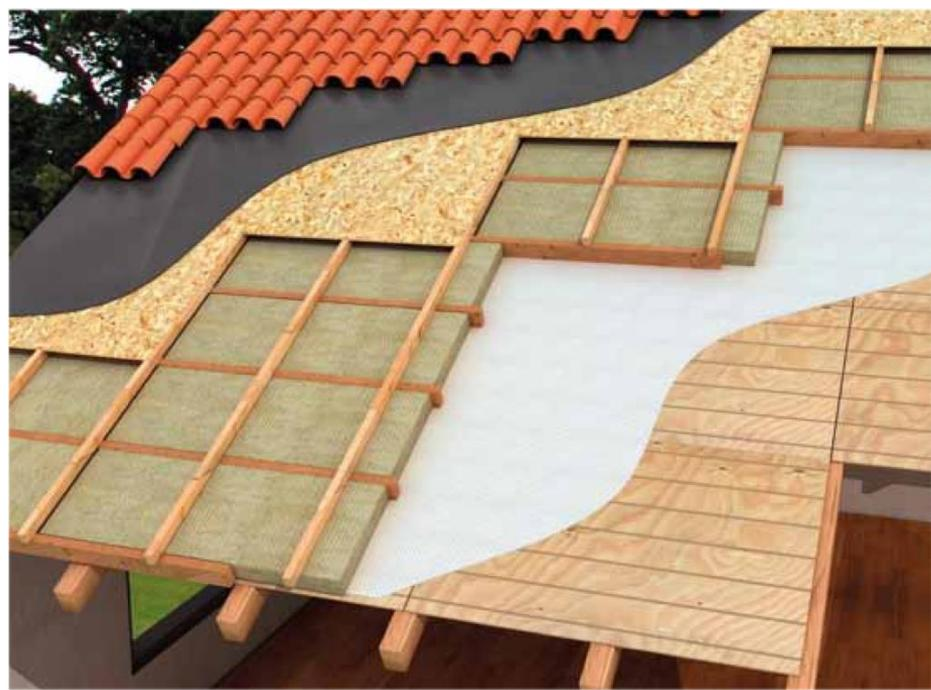
La soluzione tecnica dell'isolamento all'estradosso ventilato con pannelli non sottoposti a carico è la soluzione maggiormente adottata nella costruzione di solai in legno.
